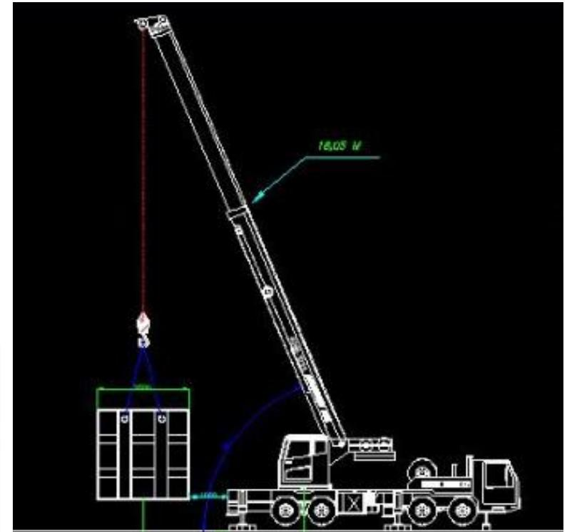
Detalhamento completo de raio peso dimensões com legenda incluindo acessórios.
